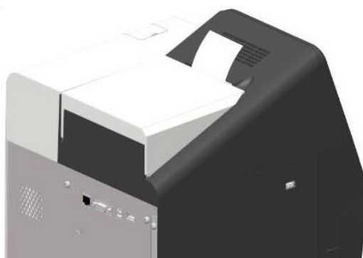
Figura 32 – Tampa da impressora fechada e papel corretamente posicionado
