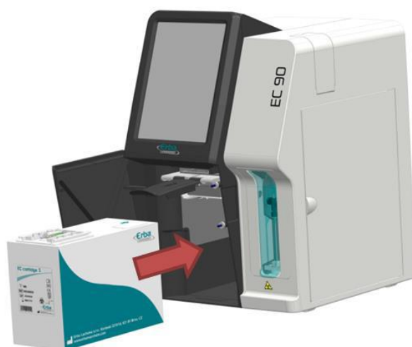
Figura 189 – Inserção do cartucho EC Cartridge
