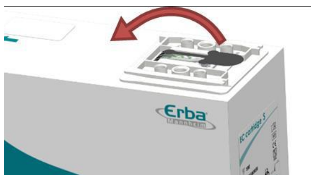
Figura 188 – Remoção do filme sensor
