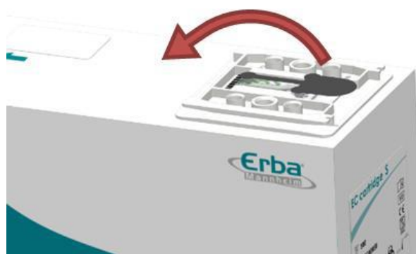
Figura 24 – Remoção do filme sensor
