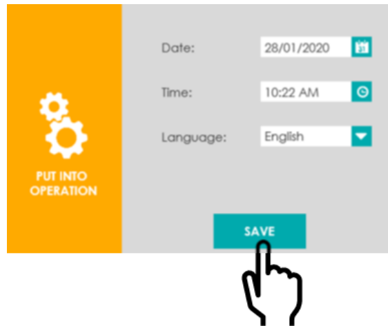
Figura 19 – Janela de configuração “PUT INTO OPERATION”
