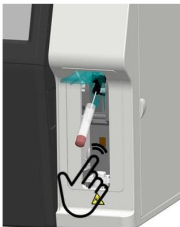
Figura 76 – Acionando o sensor de proximidade
