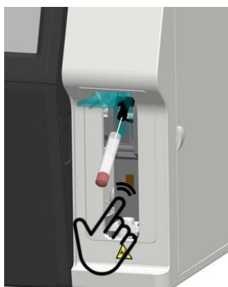
Figura 43 – Acionando o sensor de proximidade
