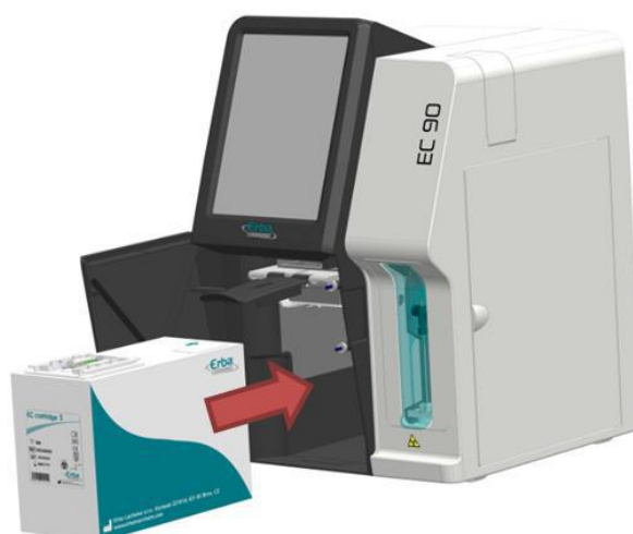
Figura 172 – Inserção do novo cartucho EC Cartridge
