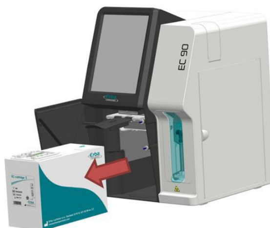
Figura 181 – Remoção do cartucho EC Cartridge
