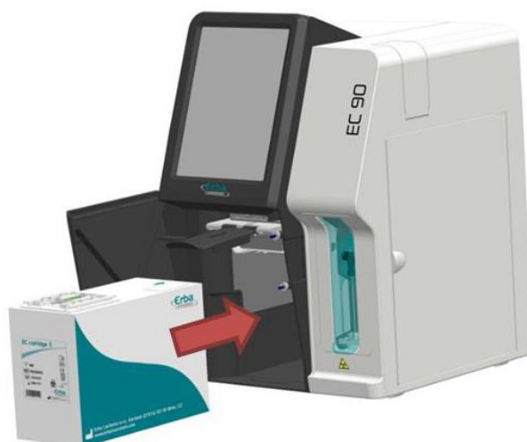
Figura 25 – Inserção do cartucho EC Cartridge
