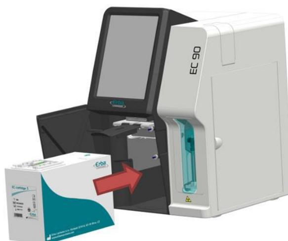
Figura 172 – Inserção do novo cartucho EC Cartridge
