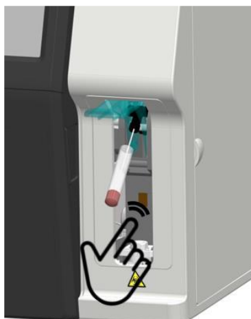
Figura 76 – Acionando o sensor de proximidade
