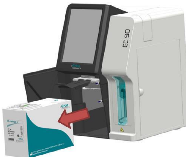
Figura 169 – Remoção do cartucho EC Cartridge
