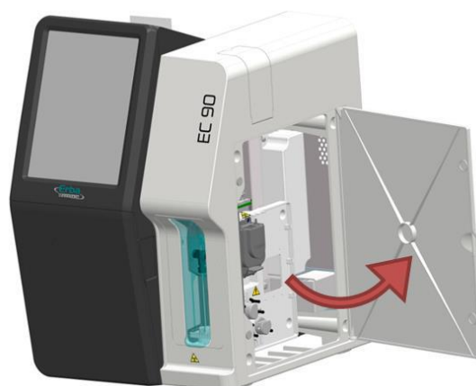
Figura 209 – Porta de manutenção aberta
