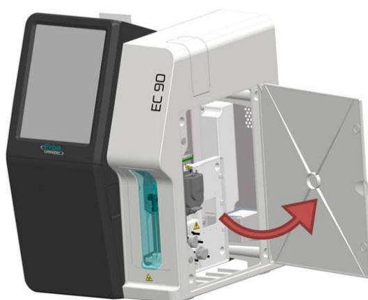
Figura 148 – Porta de manutenção aberta
