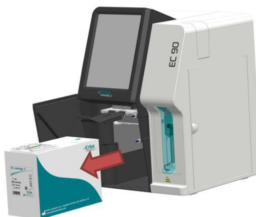
Figura 195 – Remoção do cartucho EC Cartridge
