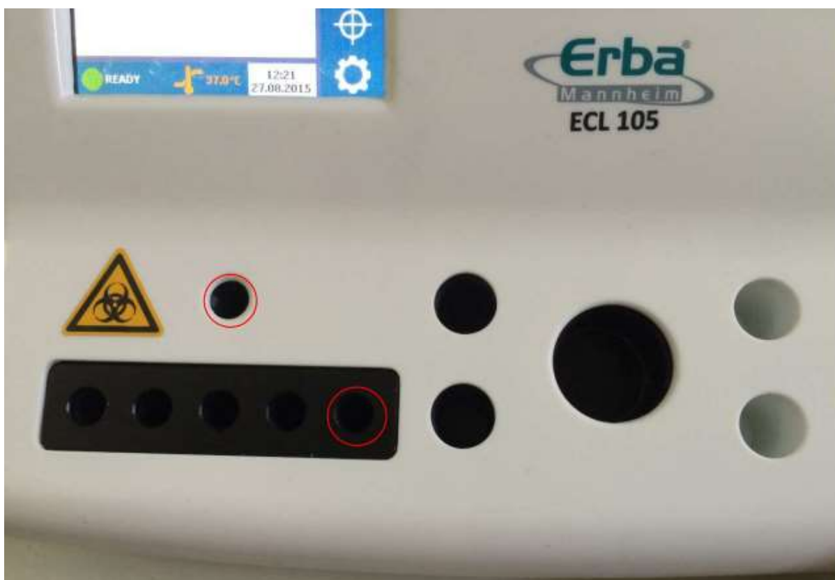
Figura 8: pontos de verificação de temperatura: canal de medição e 5ª posição de incubação
