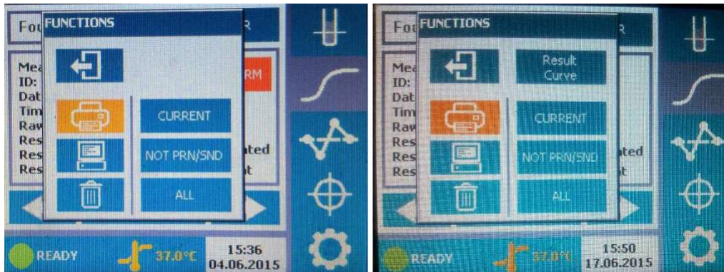
Figura 7: Opções das Funções: (a) sem chave de dados presente na USB; (b), com a chave de dados inserida na USB.
