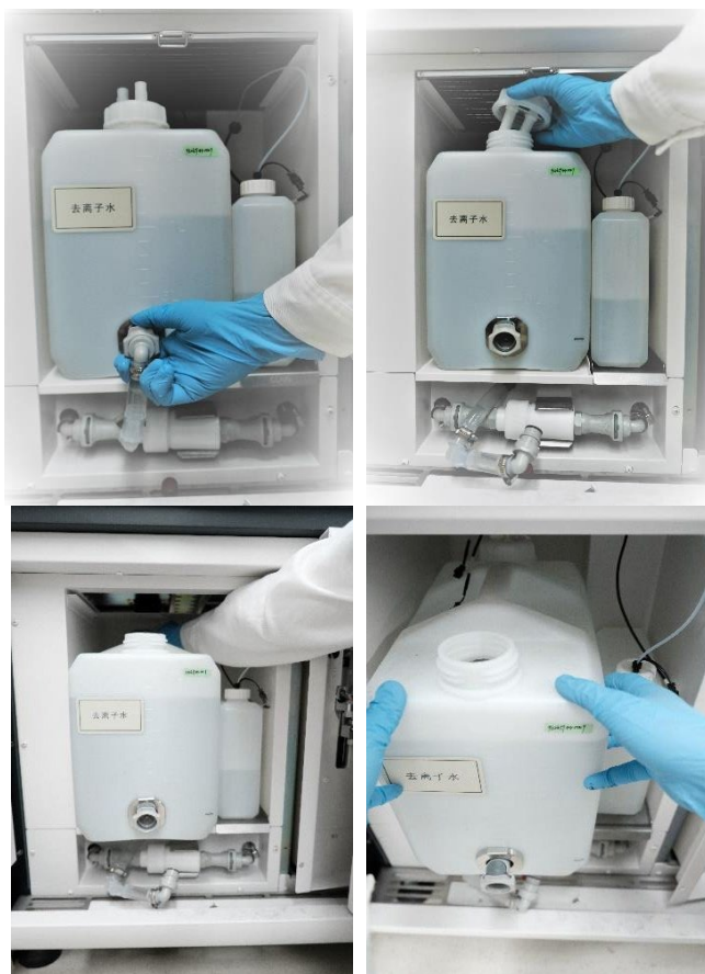
Figura 11.6 Remover o tanque de água deionizada
